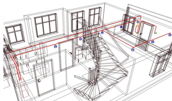
Figur 4.4: Til venstre IFC-fil av Boligprodusentenes demonstrasjonsbolig "Blåbærlia" ( www.demohuset.no ). Til høyre: elektroinstallasjonsfil importert på IFC-format inn i bygningsfil
